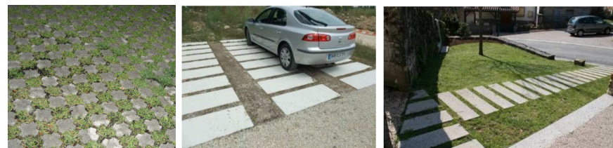
Exemples de stationnements perméables.
